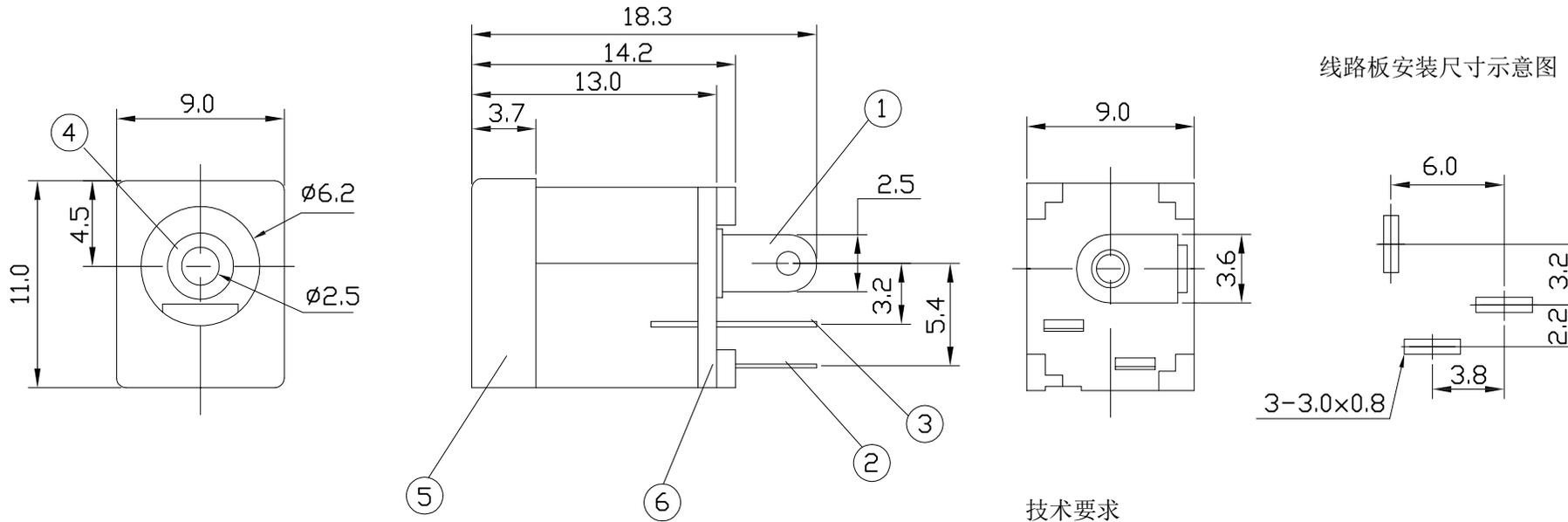
线路板安装尺寸示意图
