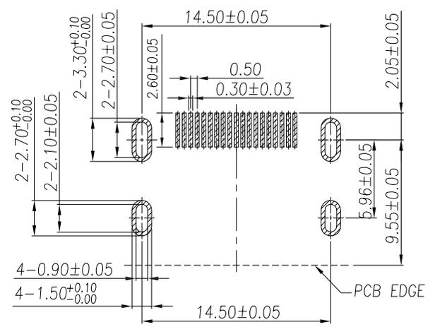
RECOMMENDED PCB LAYOUT (T:1.60mm)
