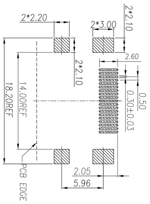
RECOMMENDED PCB LAYOUT (T:1.60mm)
